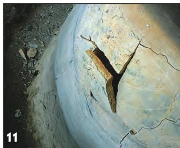
Отрицательный результат — тоже результат! Купол испытанной высокой температурой не выдержал.
