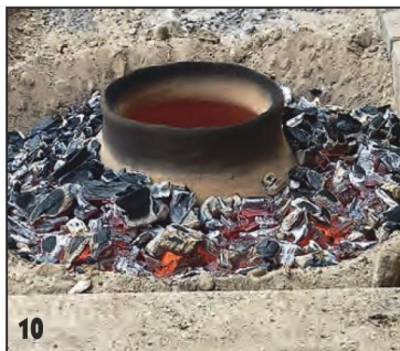
Жёсткое испытание — при обжиге купола обжогил его горящими углями снаружи и развёл огонь внутри тандыра.
