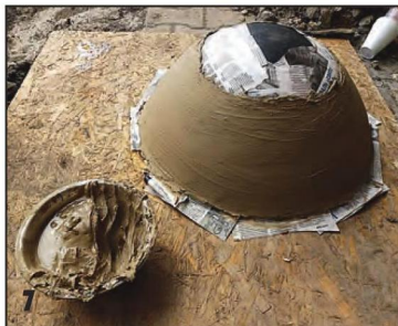
7 Чугунный котёл стал отличным шаблоном для изготовления купола тандыра из глины.
