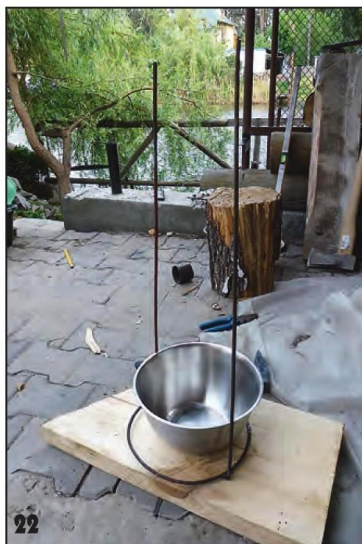
22 Для подвешивания в тандыре миски из нержавейки сделал каркас, который приварил к поперечине кольцевого подвеса.
