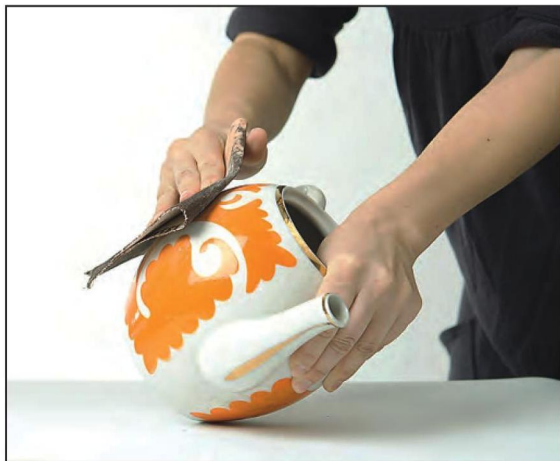
Поверхность чайника перед покраской обрабатывают шкуркой.
